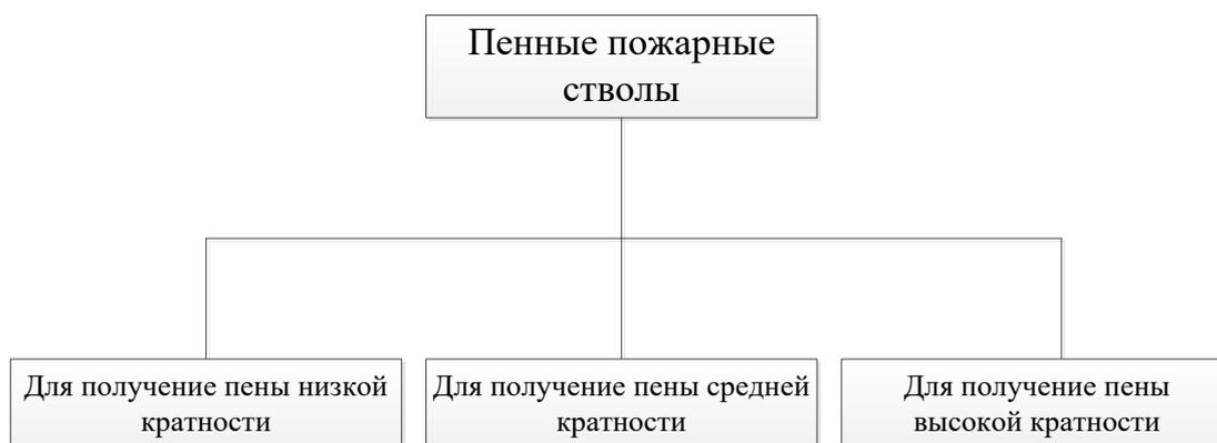
Рис. 1 Пенные пожарные стволы
