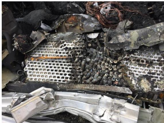
Рисунок 1 –Последствия возгорания литий-ионных батарей в результате ДТП
