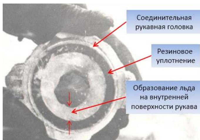
Рисунок 1 – Промерзание рукавных линий
