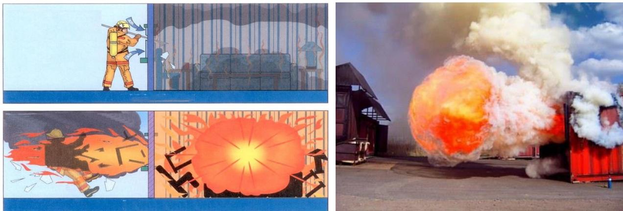
Рисунок 1 – Процесс образования выброса пламени
