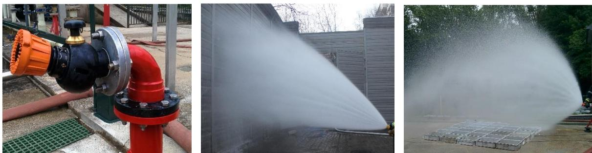
Рисунок 3 – Испытания оросителя
